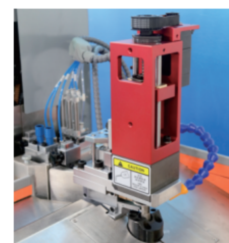
新款弯曲剪切模具 New Bend&Cut Structure
